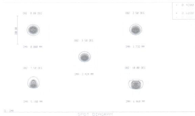
Рисунок 4. Изображения точки в зависимости от угла поля зрения, получаемые созданной оптической системой
